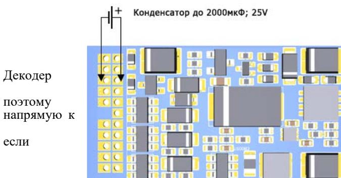
LGR2-P22 (также, как и SoundGT2.1) имеет встроенный ограничитель тока и напряжения заряда конденсатора, конденсатор емкостью до 2000мкФ можно подключать контактам «GND» и «Конденсатор +». При этом можно использовать конденсатор, рассчитанный на 16В. Даже напряжение на рельсах выше 16В.
